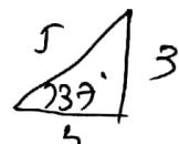
$$i(t) = 10\sqrt{2} \sin(100\pi t - 37^\circ + \pi/6) \\ = 10\sqrt{2} \sin(100\pi t - 37^\circ + 30^\circ)$$
